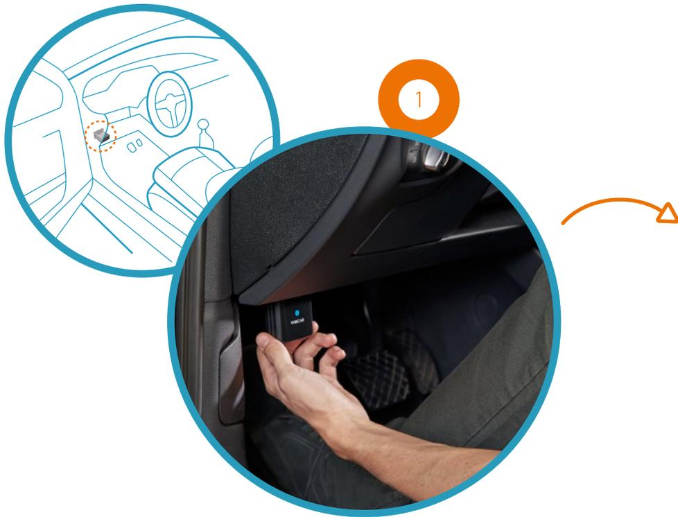
Um Kilometerdaten an die Vimcar-App weiterzugeben, nutzt der Fahrtenbuchstecker die OBD-Schnittstelle im Fußraum Ihres Wagens. OBD steht für On-Board-Diagnose und ist als automatisiertes Prüfsystem standardmäßig vorhanden – in Fahrzeugen mit Ottomotoren seit 2001, in Dieselfahrzeugen seit 2004.
